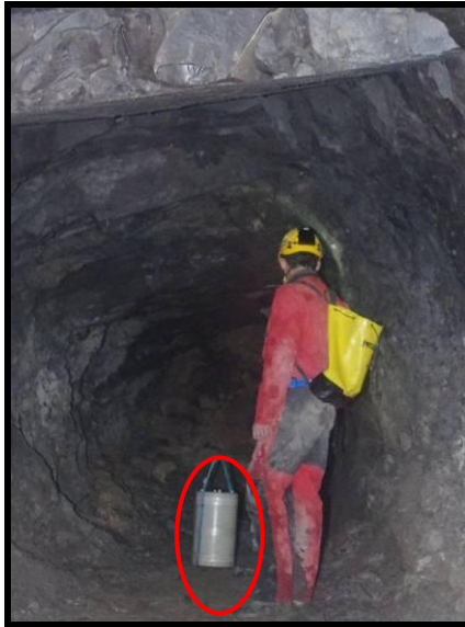
Photographie 1 : Balise émettrice positionnée dans une galerie souterraine
